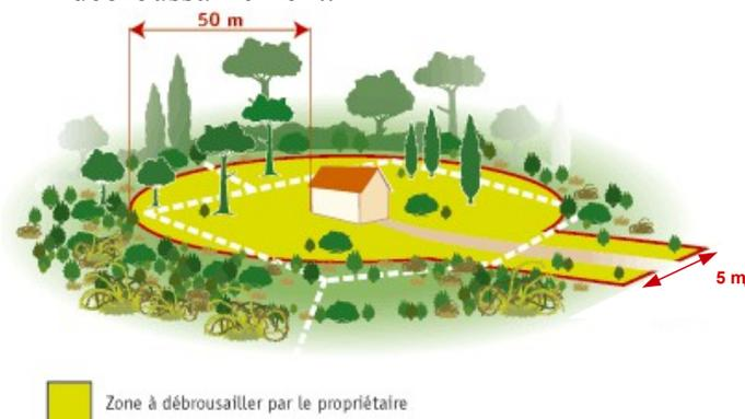
*Schéma type de l'application du débroussaillage réglementaire autour d'une construction et de sa voie d'accès privée*
